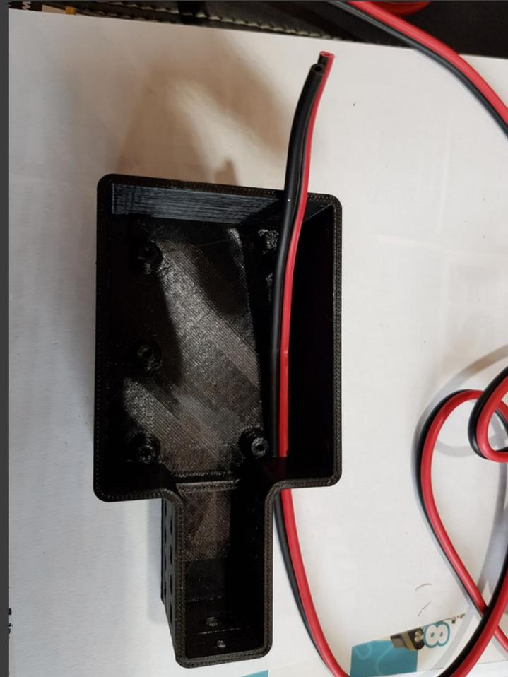
Dénuder les fils pour passer par le dessous du circuit imprimé et souder par le dessus. Attention à la polarité !
