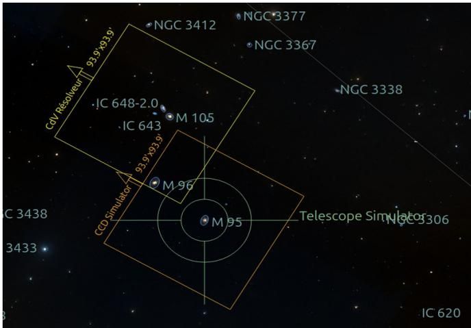
Sur l'image ci-contre, en orange la position théorique du capteur par rapport à la cible, en jaune le résultat de la solution astrométrique, sans recentrage. Une fois l'alignement effectué, les deux se confondent.
