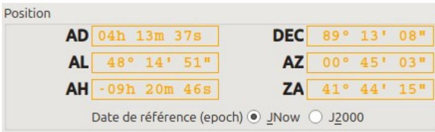
Les coordonnées courantes du télescope en AD et DEC, AZ et ALT, en angle horaire HA et DEC.
