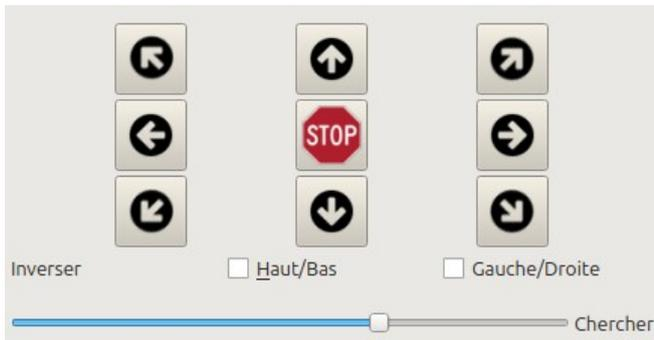
En dessous, vous disposez d'une raquette virtuelle. Le slider permet de fixer la vitesse de déplacement: guidage, centrage, chercher, max. De plus le bouton *T Contrôle de la monture*, ouvre une raquette virtuelle dans une fenêtre flottante, avec des options supplémentaires.
