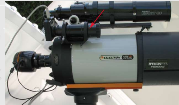
Exemple de lunette guide pointée par la flèche rouge.
