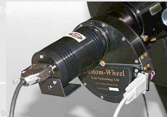
Roue à filtre manuelle ou Pilotée
